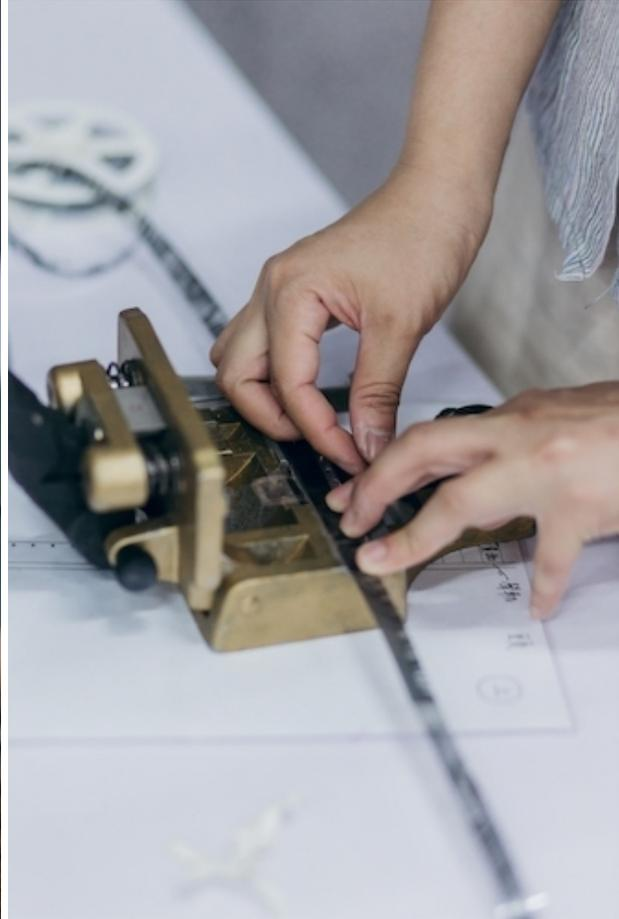
接片器 Splicer，附有刀片和膠帶，一般適用於拷貝片的快速剪接（空總臺灣當代文化實驗場 C-LAB 提供）
